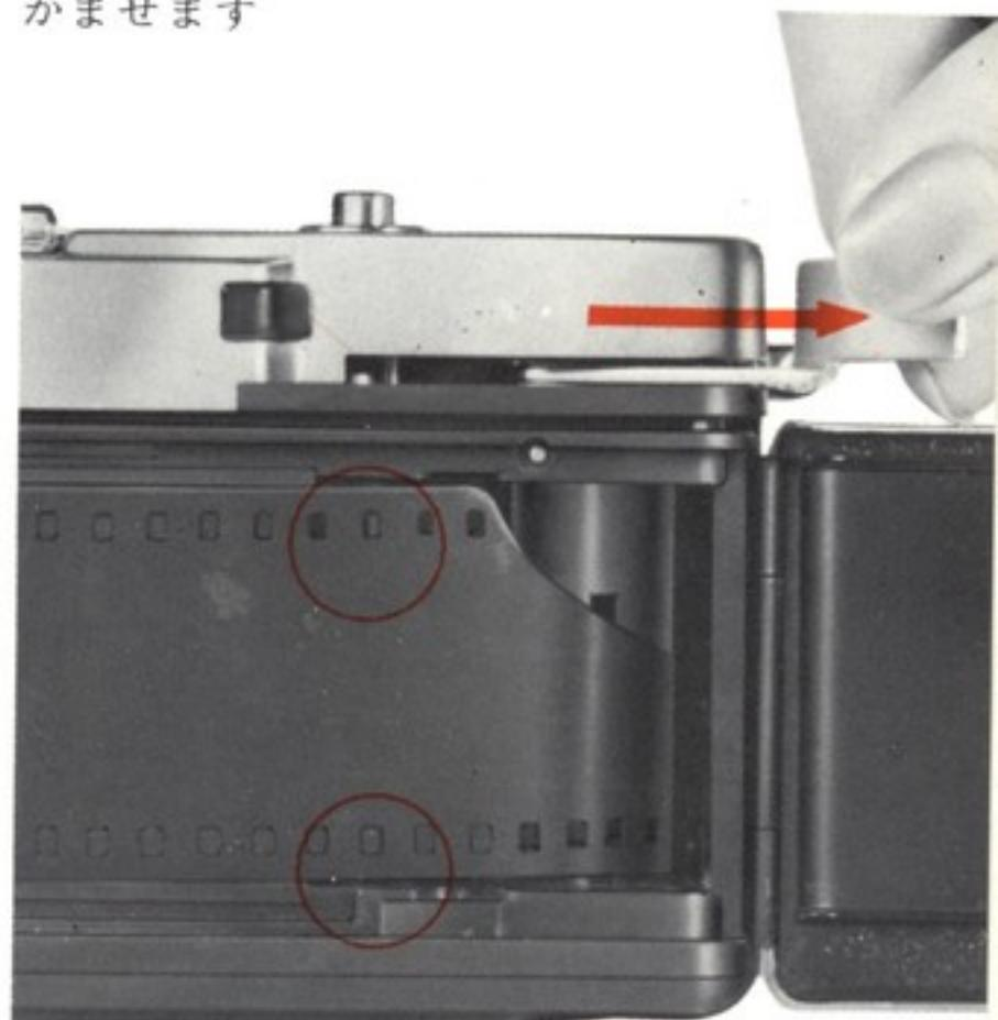
**5** フィルムが送られているのを確認して裏蓋を閉じ、そのあと巻上げレバーがとまるまで回してシャッターボタンを押します。この操作を繰返してフィルムカウンターに①を出します
